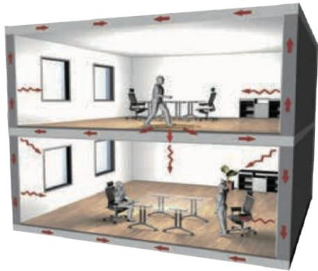
MUTE FLOOR來自德國生產製造，擁有高品質、耐衝擊的樓板隔音墊。主要由聚氨酯黏合再生橡膠並搭配其他原料製成，為環保永續盡一份心力，堅持要求產品品質與性能提升，有效降低樓地板撞擊聲，並提升居住環境品質與舒適程度。
